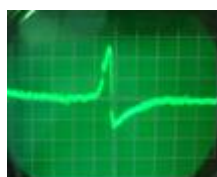
NMR 磁場測定器のモニタ波形 (EM-11050P 型)
